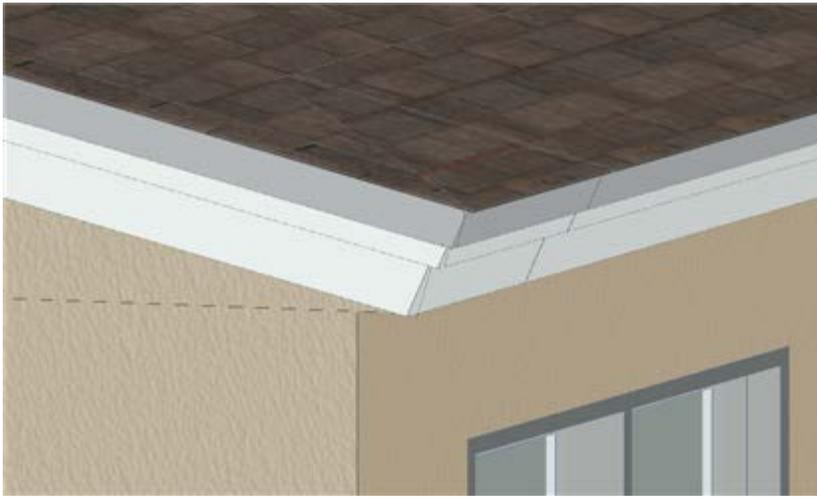
Un'ottima soluzione è una variante del metodo di cui sopra per l'utilizzo di **Solid Element Operazioni** di sottrarre lo spazio negativo di creare una trave di coda. Basta creare un profilo che definisce lo spazio negativo per le modanature, e estrarre lungo gli gronda del tetto e rastrello, quindi sottrarre utilizzando SEO da semplice fascia rettangolare travi a creare le forme di stampaggio.
